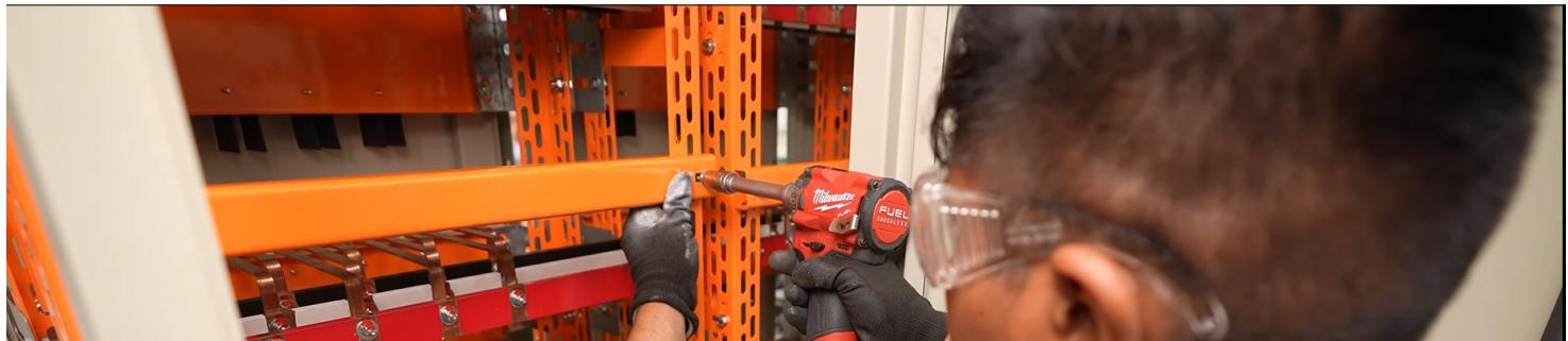
Os tipos de compartimentações de painéis elétricos 1, 2a, 2b, 3a, 3b, 4a e 4b são categorias definidas na norma NBR IEC 61439, que estabelece os requisitos para a construção e o desempenho de painéis elétricos de baixa tensão. Cada tipo de compartimentação serve a propósitos específicos, oferecendo diferentes níveis de proteção e isolamento para os componentes elétricos.
